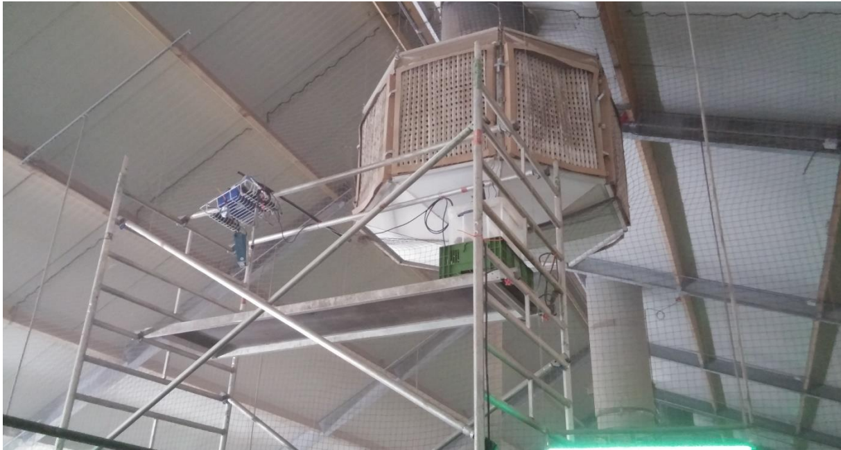
Figuur 1 Opstelling meetapparatuur fijnstof bij een droogfiltersysteem in een leghennenstal, foto WUR
